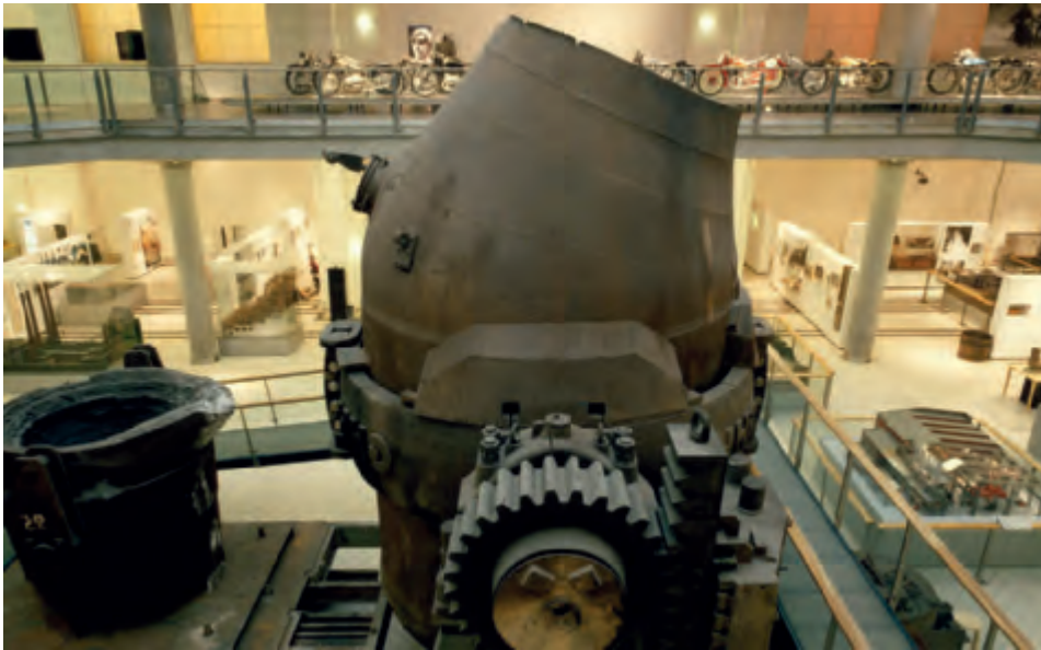
Mit dem 1949 von der Voest entwickelten Linz-Donawitz-Verfahren („LD-Verfahren“) werden heute rund zwei Drittel der Weltrohstahlproduktion hergestellt
